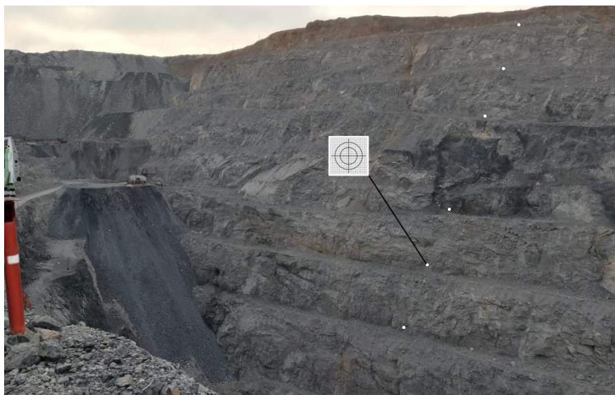
Сурет 3.12 - Жарқырағыш маркалардың көмегімен карьер беткейлерін мониторингтеу [31]
