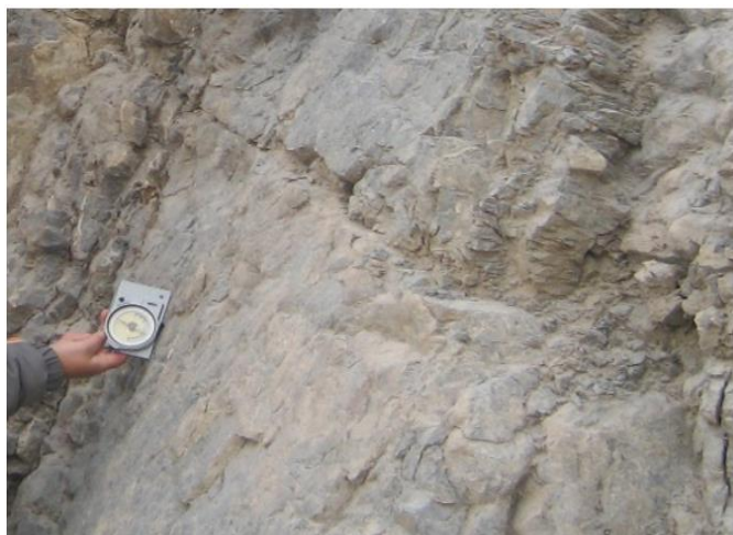
Сурет 2.7 – Таужыныстар массивінің жарықшақтылығын тау компасымен өлшеу
