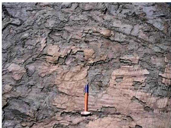
Сурет 2.6 – Карьер жағдаулары таужыныстарының жарықшақтылығы [28]
