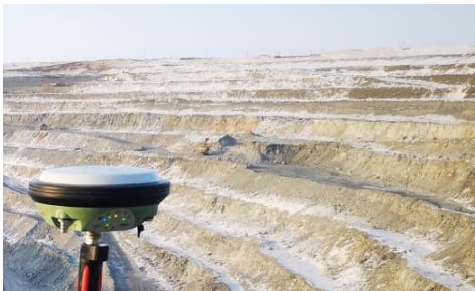
Сурет 3.14 – Leica GS 14 қабылдағышымен карьер беткейінің орнықтылығын зерттеу
