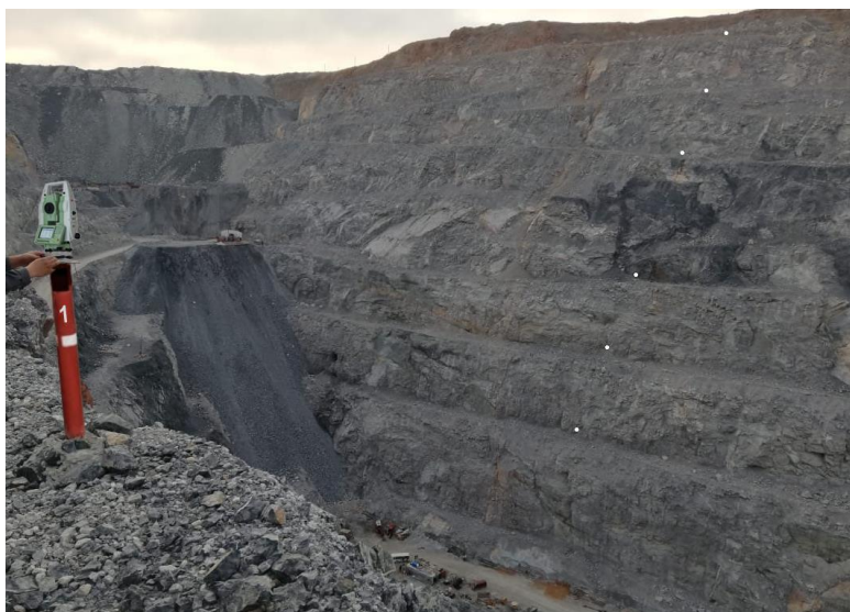
Сурет 1.10 - Leica TCR 1201 тахеометрімен өлшеу жүргізу
