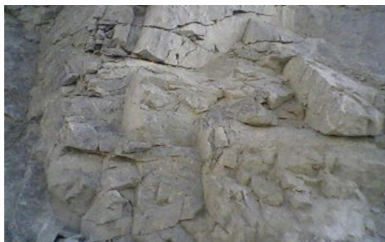
Сурет 2.5 – Массивтегі таужыныстардың жіктемесі: а) Екінші блоктың жарықшақтары; ә) төртінші блоктың жарықшақтары
